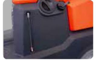
**Porta di iniezione dell'acqua e indicatore del livello dell'acqua**
